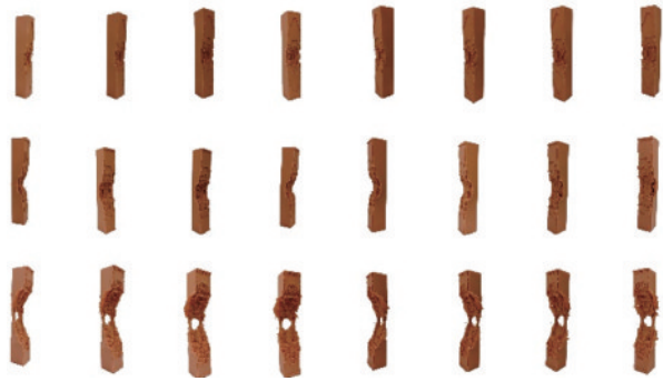
图 13 带损伤钢筋混凝土柱 3D 打印模型测试图片
